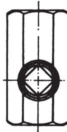
Forme interne 4 côtés pour diamètre extérieur du tube (A) 12 et 18
