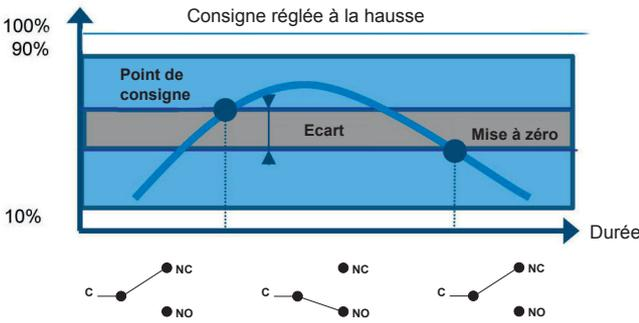
Le point de consigne et la mise à zéro doivent être compris entre 10% et 90% de l'échelle.
