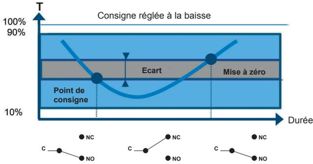
Un élément sensible à "tension de vapeur" actionne un microrupteur par l'intermédiaire d'un levier. Le réglage de la consigne est obtenu par un ressort comprimable monté en opposition.
